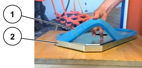
Figuur 15: Verwijderen zuignaprubber
