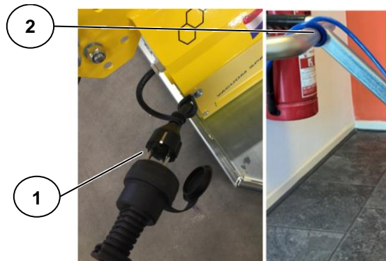
Figuur 9: Aansluiten netkabel (voorbeeld)
